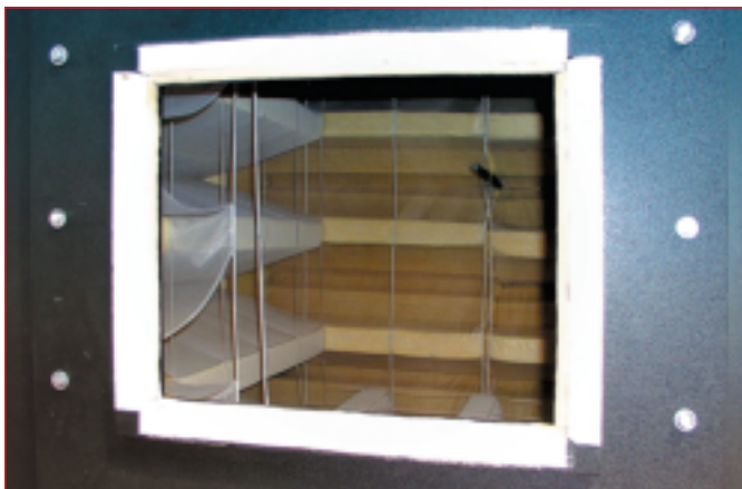
Wnętrze niewielkiej komory bezchowej, w której mierzone są wszystkie bez wyjątku zestawy głośnikowe opuszczające montownię. W zależności od typu zestawu zmienia się płytę frontową komory, tak by można było wsunąć do niej przedmiot pomiaru.
