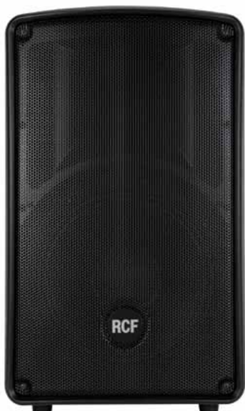
HD 12-A jest zestawem dwudrożnym, w którym tuba drivera oraz porty bass-reflex zintegrowane zostały z obudową z tworzywa. Zgodnie z obecnymi trendami maskownica w pełni zasłania panel przedni.
