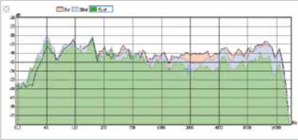
Pomiary przeprowadzone pod kątami 0, 30 i 45 stopni w poziomie względem osi głośników obrazują prawidłowe działanie tuby. Wykresy są niemal równoległe względem siebie, zatem równowaga brzmieniowa poza osią nie zostaje zachwiana.
