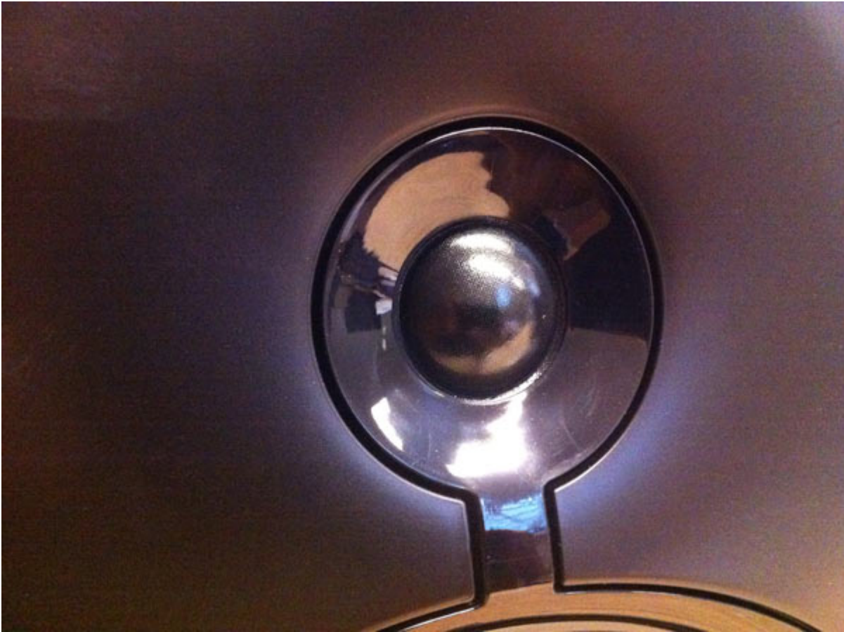
Ośmio calowy woofer wykonany z kompozytu z włókna szklanego
