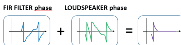
Rys.3 - Suma fazy filtru FIR z fazą głośnika
